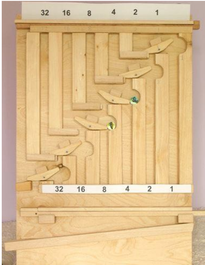
http://woodgears.ca/marbleadd/ Bascule modifiée pour addition (gestion de la retenue)
